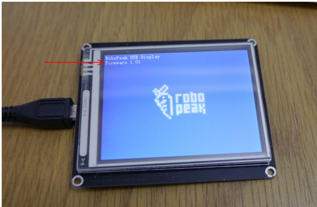
Figure 4 RoboPeak Mini USB Display Firmware Version Display
